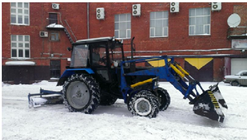
***Рис. 1. Дорожная уборочно-подметальная машина на базе трактора МТЗ-80***
