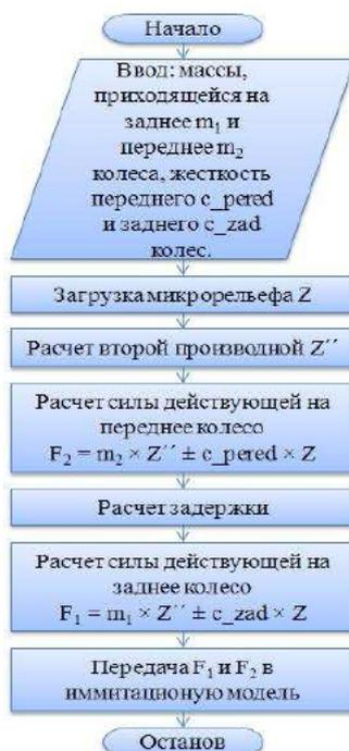
Рис. 4. Блок-схема алгоритма работы подсистемы пересчета кинематического возбуждения в силовое
