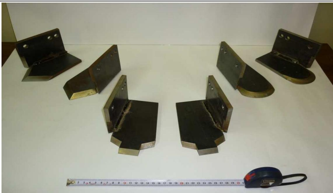
*Рис. 2. Скребки с разной формой режущей кромки*
