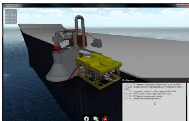
Рис. 4. Программа визуализации состояния моделей. Вид стыковочного устройства, робота и танкера
