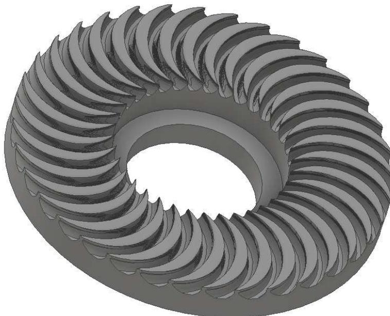
**Рис. 6. Твердая 3D-модель плоского зубчатого колеса с круговыми зубьями**
